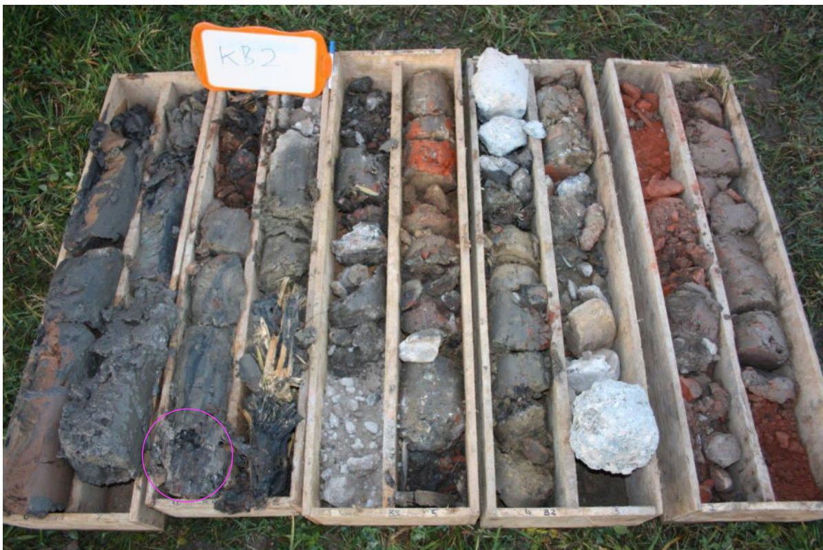
Bild 2: KB 2 (ohne letzten Bohrmeter); 7,4-8,3 m Industrieschlammanteile (evtl. Galvanikschlamm)
