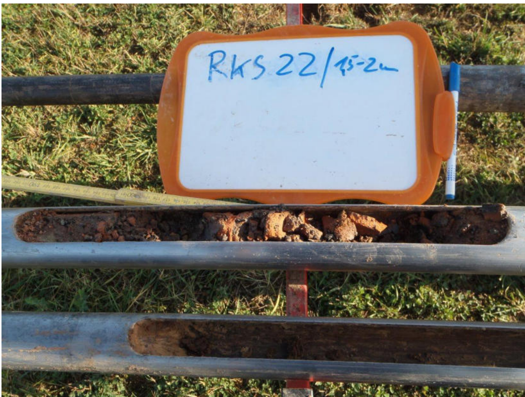
Bild 8: RKS 22 / 1,5 – 2,0 m mit Papierschlammanteilen
